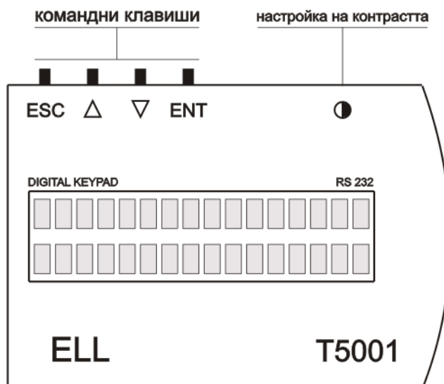
Фигура 6-1 Терминал для настройки T5001
