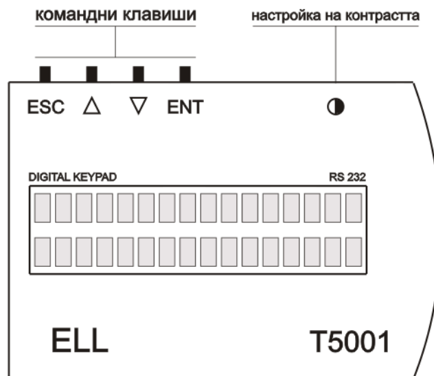
Рисунок 6-1 Терминал для настройки T5001
