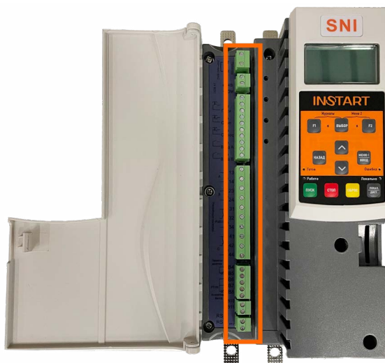
Рисунок 5 – Демонтаж клемм управления устройства плавного пуска серии SNI
