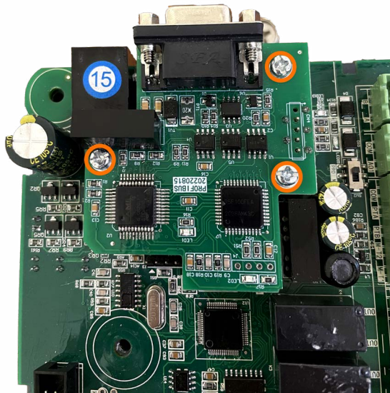
Рисунок 11 – Крепежные винты платы расширения SNI-DP-S
