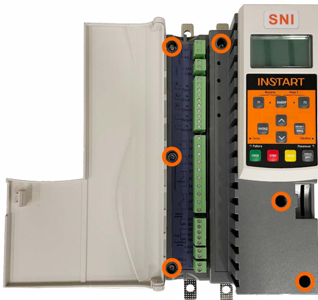
Рисунок 15 – Винты крепления корпуса устройства плавного пуска
