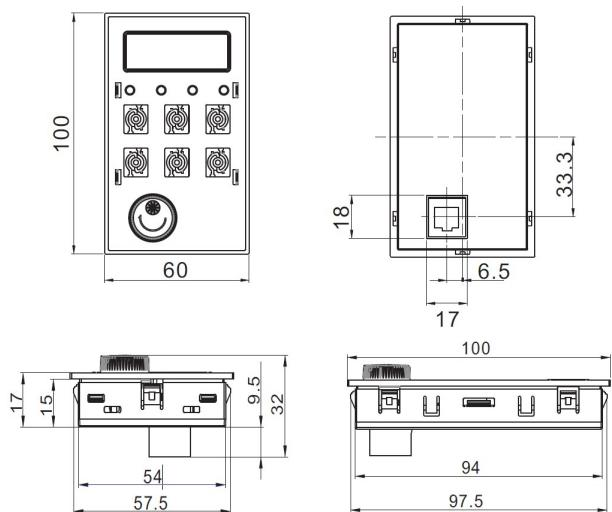
Разметка отверстия для монтажа
