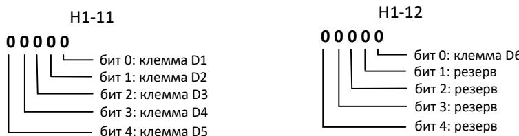
[бит = 0]: Функция активируется при замыкании клеммы (NO контакт).
