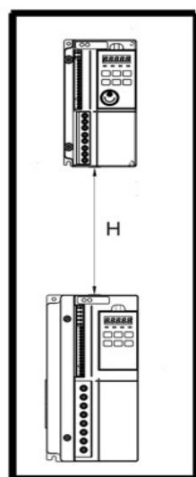
2.2.3. При размещении преобразователя частоты в шкафу необходимо обеспечить соблюдение температурного режима внутри шкафа с учетом собственного тепловыделения преобразователя.
